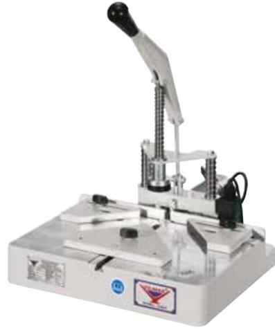
Ahşap profillerin köşe birleştirme kanallarını acar.
