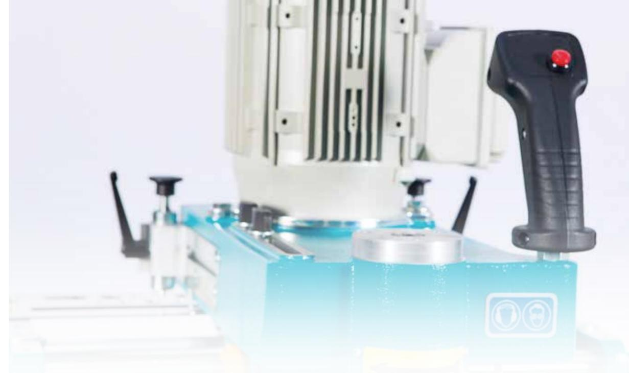
3 mm kalınlığa kadar Alüminyum ve PVC kapı ve pencere profillerindeki, barel yuvası delikleri, su tahliye kanalları, menteşe ve ispanyolet yeri gibi birçok frezeleme ve delik delme işlemleri için kullanılır.
